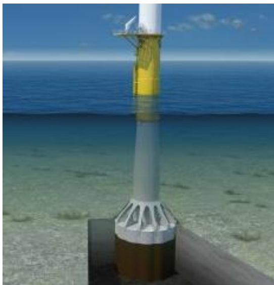
Figura 1 – Esquemático de turbina com fundação tipo mono-estaca de sucção.
