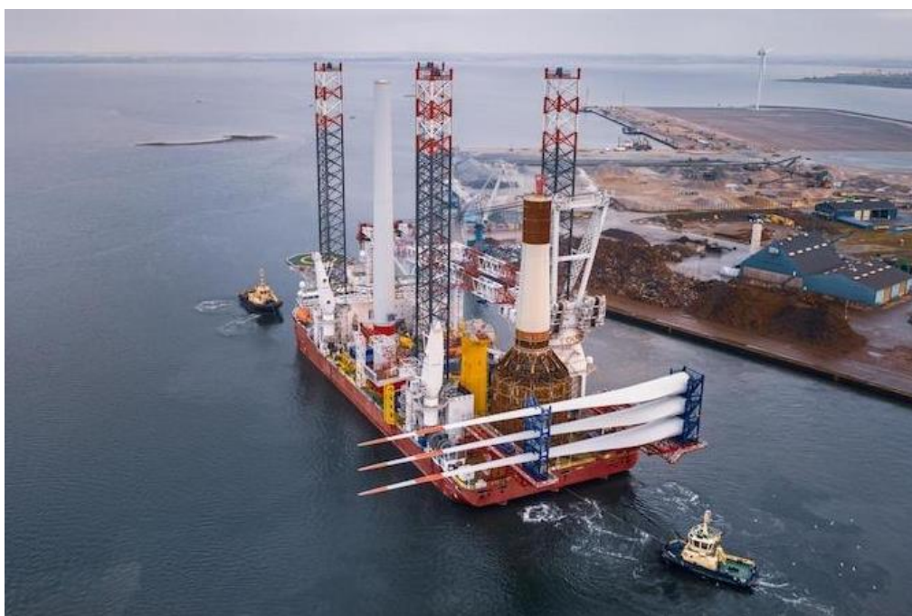
Figura 36 – Navio Scylla transportando a estrutura para o campo eólico de Deutsche Bucht.
