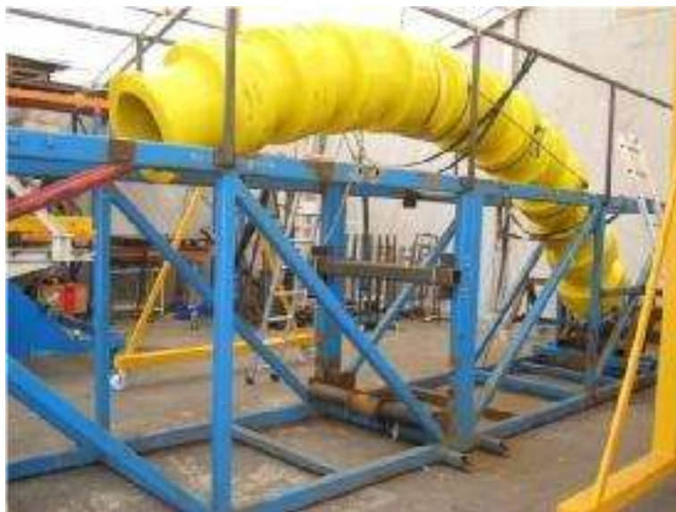
Figura 2-7 Restritor de curvatura (vértebra).
