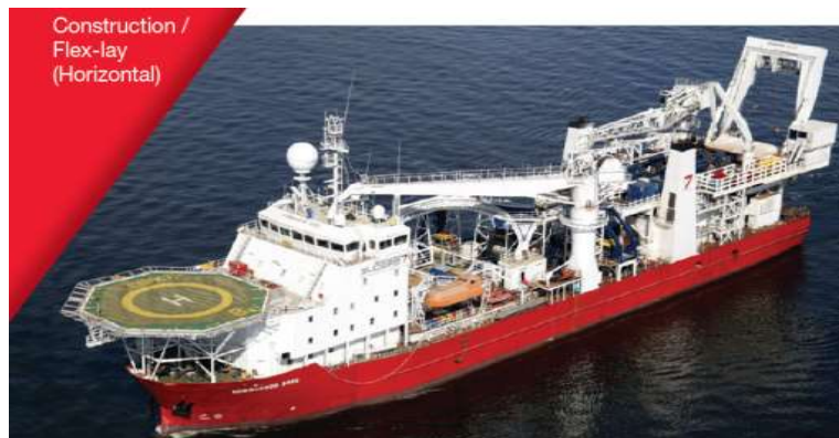
Figura 3-1 - PLSV HLS Kommandor 3000. Fonte: Catálogo Subsea 7.
