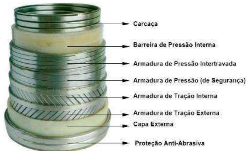
Figura 2-4 Camadas de um duto flexível. Fonte: PLATEC INOVAPETRO.
