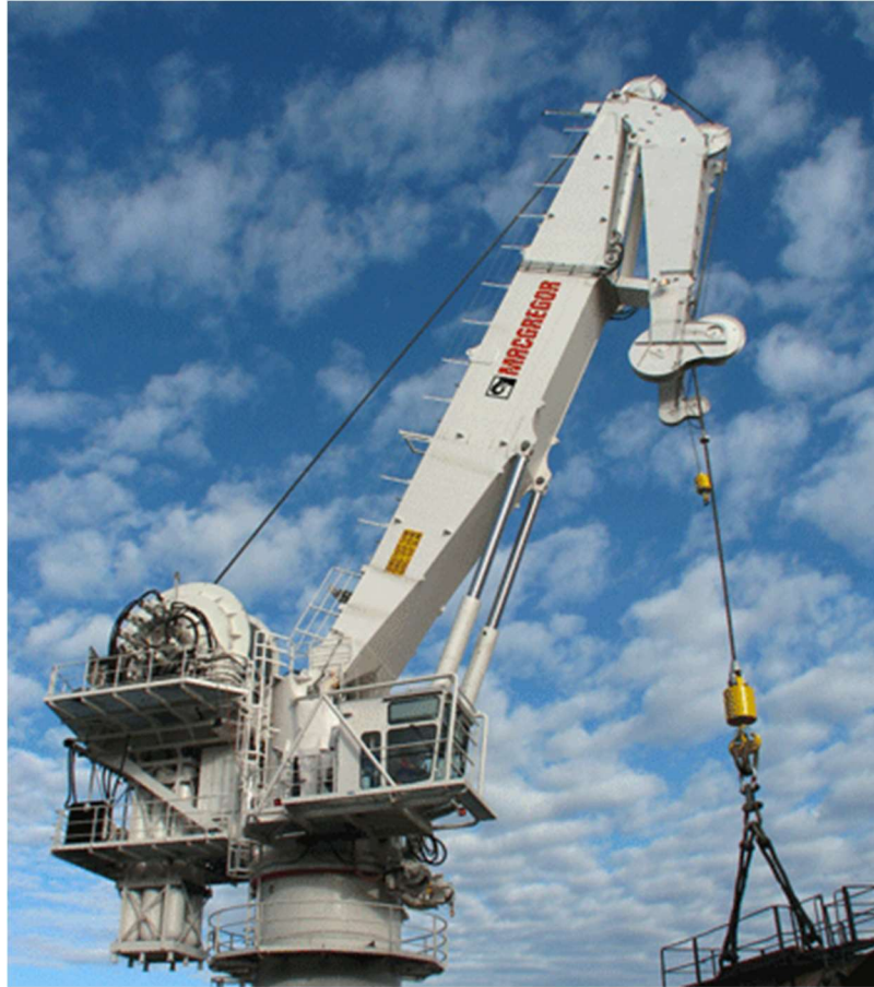
Figura 3-5 Guindaste MacGregor com compensador de ondas para operações offshore. Fonte: KHL News, 2013
