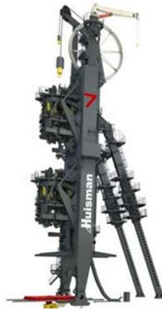
Figura 3-4 Torre de lançamento vertical. Fonte: Engenharia Naval UFRJ
