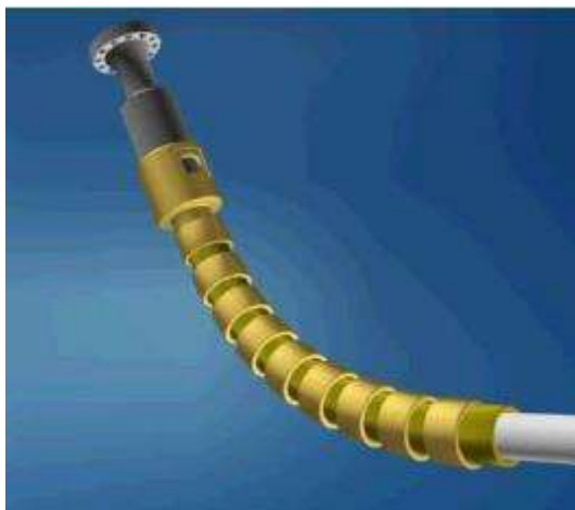
Figura 5-2 Estrutura equipada com vértebra e conector. Fonte: AGUIAR, 2016.
